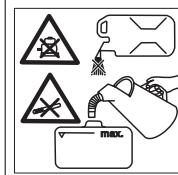
*Ne pas faire le plein lorsque le moteur tourne. Ne pas fumer en faisant le plein. Ne pas verser directement le jerrycane. Utiliser un entonnoir ou un système équivalent.*
