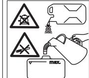
Não abastecer com o motor em funcionamento.
