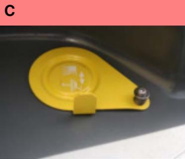
C Nass-/Trockenklappe schließen.
